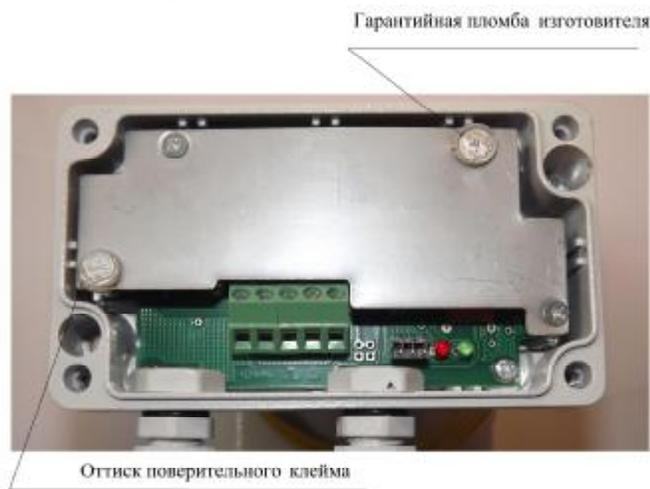
Фото 3 – Схема нанесения оттисков поверительных клейм и гарантийных пломб изготовителя на преобразователь расхода
